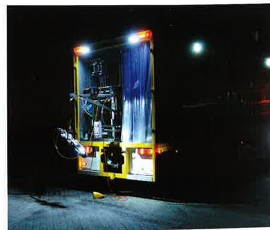
Sanierungsfahrzeug mit 360-Grad-LED-Außenbeleuchtung | Alle Fotos: Subtech GmbH
