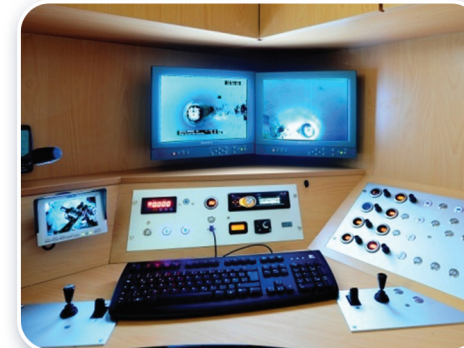
Oben: Innenansicht sanierte Muffe Unten: Bedienraum des Sanierungsfahrzeuges
