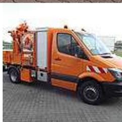
Um die Reinigung von Trockensinkkästen möglichst effizient zu gestalten und den Mitarbeitern die manuelle Entleerung zu ersparen, setzen viele Kanalnetzbetreiber auf Spezialfahrzeuge und -Maschinen. Hier punktete die Firma SubTech GmbH aus Goch in den vergangenen Jahren bei zahlreichen Kommunen, Kommunalverbänden und Dienstleistungsunternehmen, da es bei der Auswahl und Anschaffung auf Handhabung, Wirtschaftlichkeit, Zuverlässigkeit und Flexibilität ankommt.
